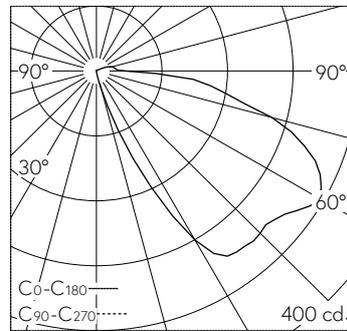
LED 4000 K 4 W 471 lm-h / CIE Flux 18 51 83 96 100 / A11 nach DIN 5040
