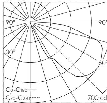
LED 3000 K 6.5 W 476 lm-h / CIE Flux 15 51 82 99 100 / A10 nach DIN 5040
