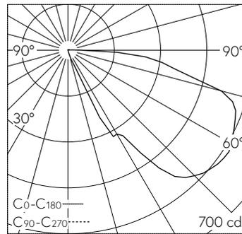
LED 4000 K 6.5 W 501 lm-h / CIE Flux 15 51 82 99 100 / A10 nach DIN 5040
