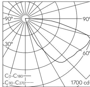
LED 3000 K 13.8 W 1164 lm-h / CIE Flux 16 50 81 99 100 / A10 nach DIN 5040
