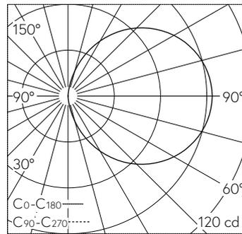
LED 3000 K 4.9 W 284 lm-h / CIE Flux 13 37 66 50 100 / C11 nach DIN 5040
