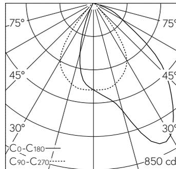
LED 3000 K 10 W 708 lm-h / CIE Flux 74 97 100 100 100 / A70 nach DIN 5040
