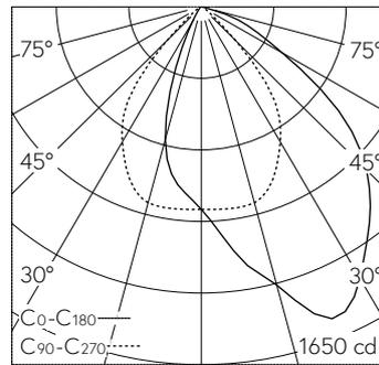
LED 3000 K 19,6 W 1623 lm-h / CIE Flux 71 96 100 100 100 / A60 nach DIN 5040
