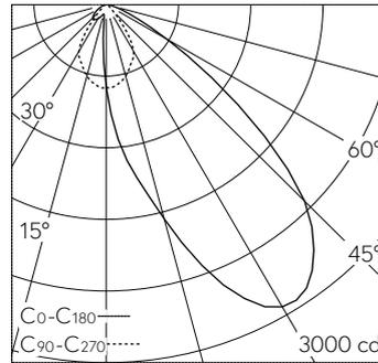
LED 3000 K 18.3 W 1979 lm-h / CIE Flux 66 95 99 100 100 / A60 nach DIN 5040
