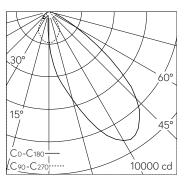
LED 3000 K 54.4 W 6209 lm-h / CIE Flux 64 95 100 100 100 / A60 nach DIN 5040
