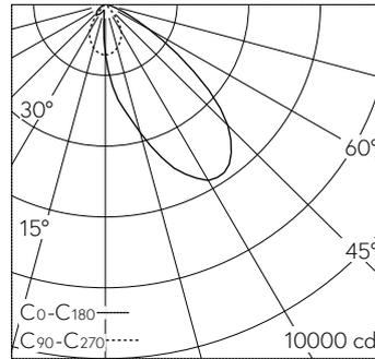
LED 3000 K 35.6 W 4024 lm-h / CIE Flux 64 95 100 100 100 / A60 nach DIN 5040
