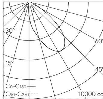
LED 4000 K 35.6 W 4151 lm-h / CIE Flux 64 95 100 100 100 / A60 nach DIN 5040
