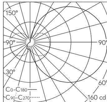
LED 3000 K 680 lm-h / CIE Flux 17 42 70 53 100 / C11 nach DIN 5040
