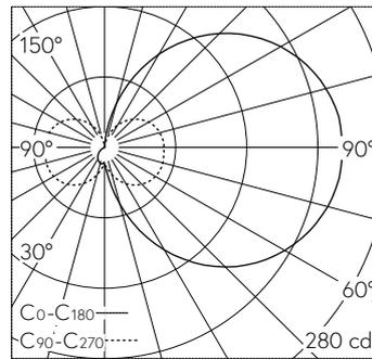
LED 3000 K 9.7 W 902 lm-h / CIE Flux 16 41 69 52 100 / C11 nach DIN 5040
