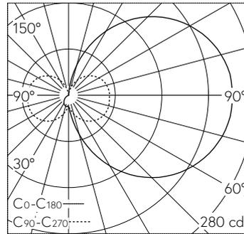
LED 4000 K 9.7 W 948 lm-h / CIE Flux 16 41 69 52 100 / C11 nach DIN 5040
