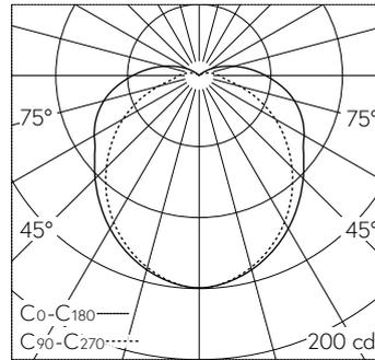
LED 3000 K 7.1 W 530 lm-h / CIE Flux 40 68 87 90 100 / A31 nach DIN 5040
