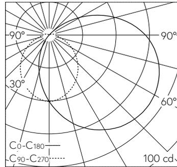
LED 3000 K 5.1 W 226 lm-h / CIE Flux 33 59 81 82 100 / B21 nach DIN 5040
