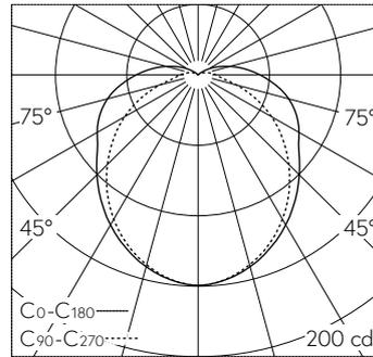
LED 3000 K 7.1 W 515 lm-h / CIE Flux 41 69 87 91 100 / A31 nach DIN 5040
