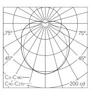
LED 4000 K 7.1 W 541 lm-h / CIE Flux 41 69 87 91 100 / A31 nach DIN 5040
