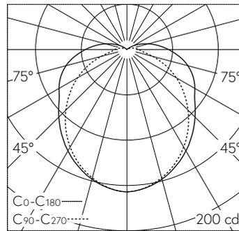
LED 4000 K 7.1 W 541 lm-h / CIE Flux 41 69 87 91 100 / A31 nach DIN 5040
