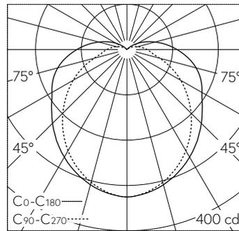
LED 4000 K 14 W 1222 lm-h / CIE Flux 39 67 86 88 100 / B31 nach DIN 5040
