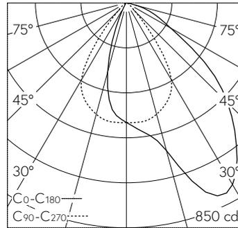
LED 4000 K 10 W 741 lm-h / CIE Flux 71 95 100 100 100 / A60 nach DIN 5040
