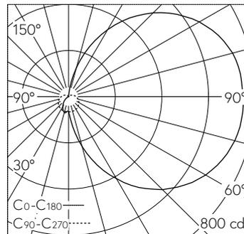
LED 4000 K 26.5 W 2482 lm-h / CIE Flux 18 43 70 55 100 / C11 nach DIN 5040
