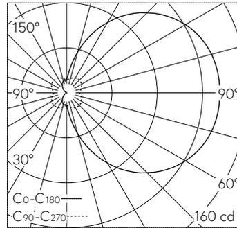
LED 3000 K 7 W 584 lm-h / CIE Flux 17 43 70 50 100 / C12 nach DIN 5040
