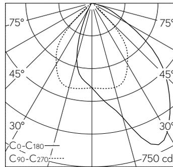
LED 3000 K 9.2 W 717 lm-h / CIE Flux 70 96 100 100 / A60 nach DIN 5040
