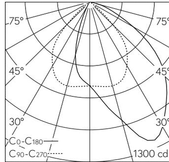
LED 4000 K 13.2 W 1352 lm-h / CIE Flux 67 94 100 100 100 / A60 nach DIN 5040
