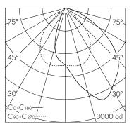
LED 4000 K 27.5 W 3109 lm-h / CIE Flux 64 92 99 100 100 / A60 nach DIN 5040
