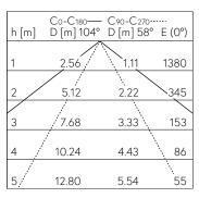
LED 3000 K 27 W 2409 lm-h 106°/58° / CIE Flux 76 97 100 100 / A70 nach DIN  $\dots$
