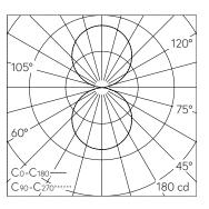
LED 4000 K 6.8 W 598 lm-h / CIE Flux 47 79 96 50 100 / C43 nach DIN 5040
