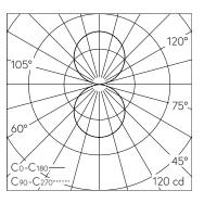
LED 3000 K 4.9 W 343 lm-h / CIE Flux 47 79 96 50 100 / C43 nach DIN 5040
