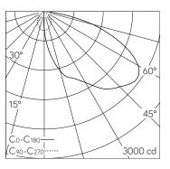
LED 4000 K 18.8 W 2649 lm-h / CIE Flux 37 74 96 100 100 / A30 nach DIN 5040
