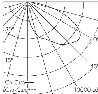
LED 3000 K 51 W 7692 lm-h / CIE Flux 37 74 96 100 100 / A30 nach DIN 5040
