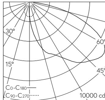
LED 3000 K 67 W 10226 lm-h / CIE Flux 37 74 96 100 100 / A30 nach DIN 5040
