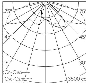
LED 3000 K 33.5 W 4554 lm-h / CIE Flux 34 68 94 100 100 / A20 nach DIN 5040
