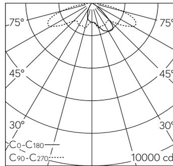
LED 3000 K 51.2 W 6904 lm-h / CIE Flux 34 67 93 100 100 / A20 nach DIN 5040
