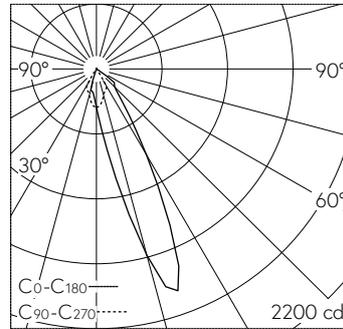
LED 4000 K 5.1 W 366 lm-h / CIE Flux 88 100 100 100 100 / A80 nach DIN 5040
