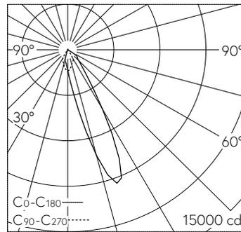
LED 4000 K 24.8 W 2160 lm-h / CIE Flux 86 100 100 100 100 / A80 nach DIN 5040
