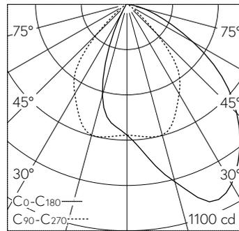
LED 3000 K 13.2 W 1212 lm-h / CIE Flux 66 93 99 100 100 / A60 nach DIN 5040
