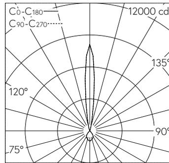
LED 4000 K 19 W 1615 lm-h / CIE Flux 88 99 100 68 100 / B84 nach DIN 5040
