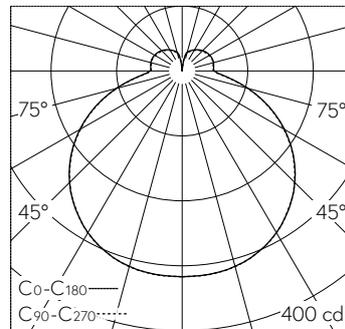
LED 3000 K 12.5 W 1450 lm-h / CIE Flux 40 70 89 79 100 / B32 nach DIN 5040
