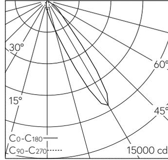
LED 3000 K 23.2 W 2587 lm-h 17.0° / CIE Flux 92 100 100 100 100 / A80 nach DIN 5...
