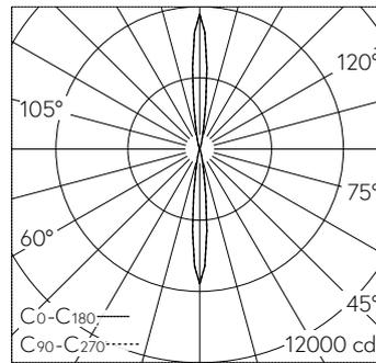
LED 3000 K 19 W 980 lm-h / CIE Flux 99 100 100 50 100 / C84 nach DIN 5040
