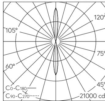
LED 4000 K 39 W 1948 lm-h / CIE Flux 99 100 100 50 100 / C84 nach DIN 5040
