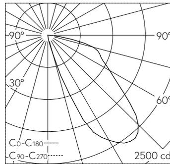
LED 4000 K 22 W 2145 lm-h / CIE Flux 31 72 93 100 100 / A20 nach DIN 5040
