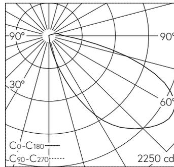
LED 3000 K 22 W 2909 lm-h / CIE Flux 19 55 86 95 100 / A11 nach DIN 5040
