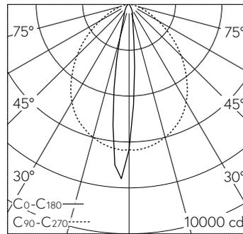
LED 3000 K 39 W 3464 lm-h / CIE Flux 76 93 99 100 100 / A70 nach DIN 5040
