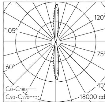
LED 3000 K 35.5 W 3245 lm-h / CIE Flux 99 100 100 50 100 / C84 nach DIN 5040
