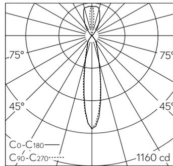
LED 3000 K 4.9 W 274 lm-h / CIE Flux 99 100 100 74 100 / B84 nach DIN 5040
