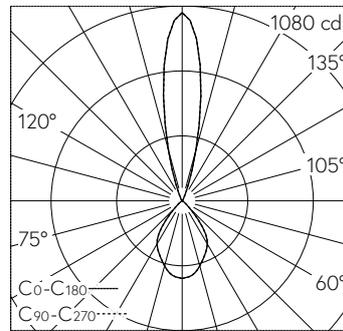
LED 3000 K 9 W 676 lm-h / CIE Flux 89 99 100 73 100 / B84 nach DIN 5040
