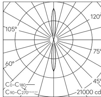
LED 3000 K 39 W 1897 lm-h / CIE Flux 99 100 100 50 100 / C84 nach DIN 5040
