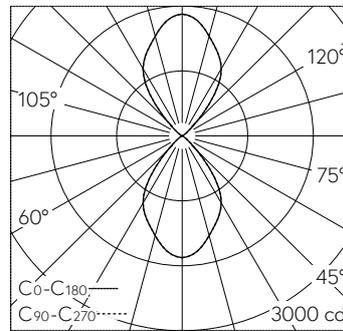
LED 4000 K 39 W 4363 lm-h / CIE Flux 86 99 100 50 100 / C84 nach DIN 5040
